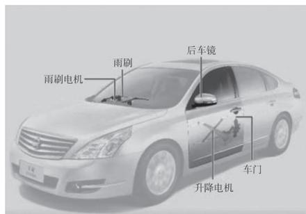
图 1-1-18 辅助电气系统的部件认识
