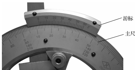
图 1-35 游标万能角度尺的读数
