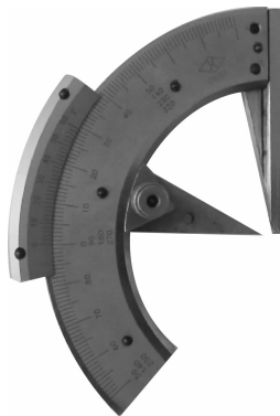
图 1-34 直角尺和直尺均不安装
