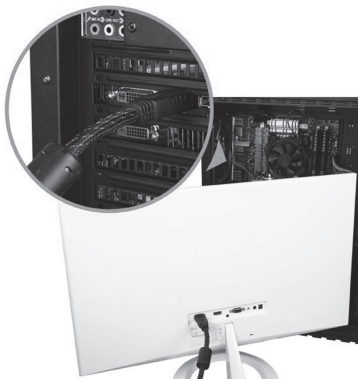
图 1-3-44 安装显示信号线
