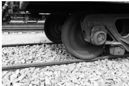
图 1-6 防溜措施撤除
