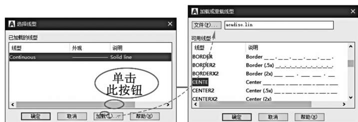
图 1-1-24 修改图层线型
