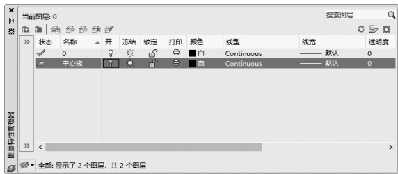
图 1-1-22 创建“中心线”图层
