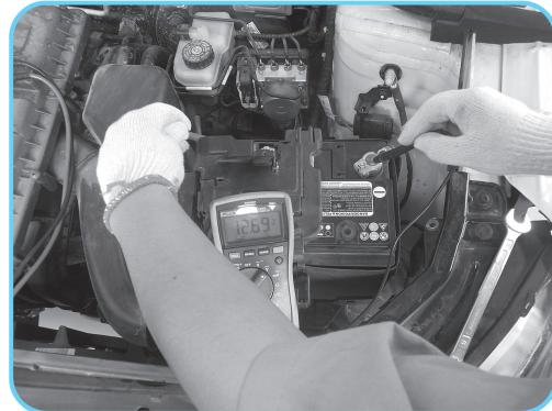
◎图 2-12 蓄电池安装后的检测
