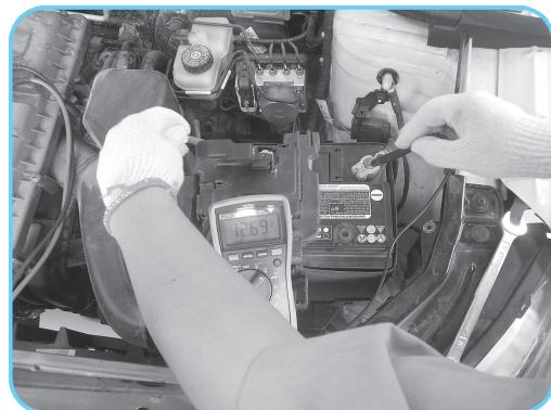
◎图 2-7 检查蓄电池静态电压
