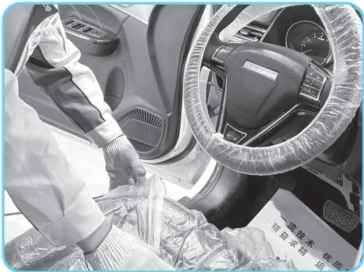
◎图 1-2 铺内部防护套
