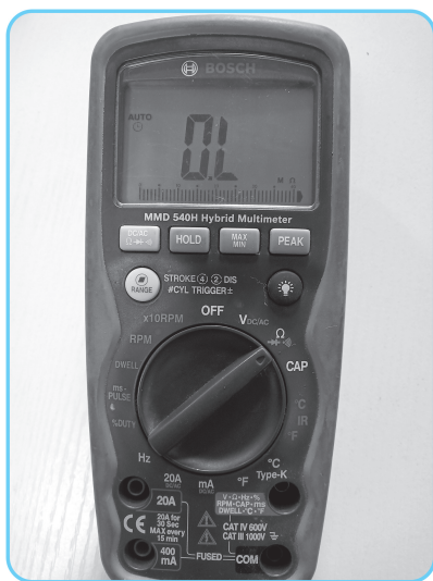
◎图 2-25 检查万用表的电量显示
