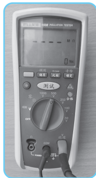
图 1-1-46 选择测试电压 500 V
