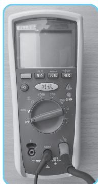
图 1-1-44 绝缘电阻测试仪红、黑表笔安装位置
