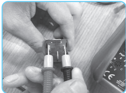
图 1-1-32 连接继电器的 86 端子和 85 端子
