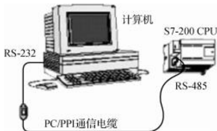
图 1-19 PLC 与计算机通信连接
