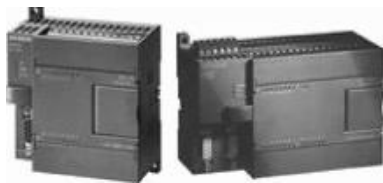
图 1-16 S7-200 PLC 的外形
