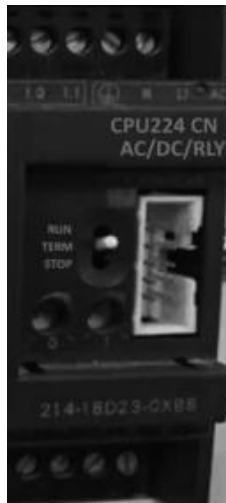
图 1-20 PLC 前盖板的内部结构
