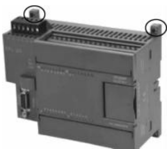
图 1-21 PLC 的底板安装
