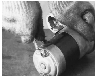
图 3-17 轴承后端盖紧固螺钉拆卸(2)
