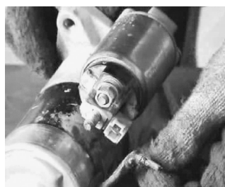
图 3-13 螺母拆卸完成
