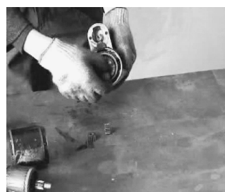
图 3-23 行星齿轮拆卸
