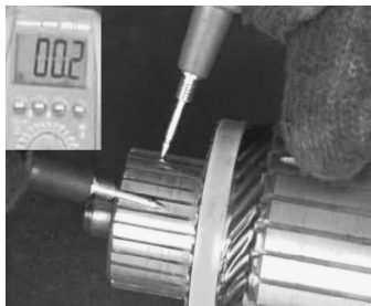
图 3-28 起动机电枢绕组导通性能的检查
