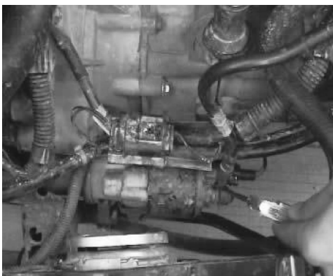
图 3-38 起动机电磁开关检查(正常状态)
