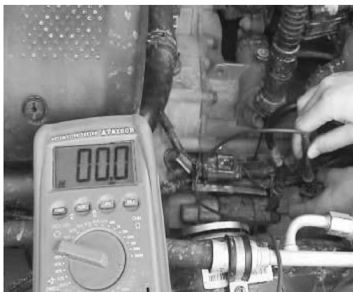
图 3-40 起动机起动信号检查(异常状态)
