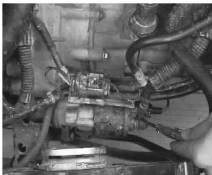
图 3-37 起动机电磁开关检查
