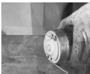
图 3-18 后端盖紧固螺钉拆卸完成
