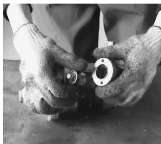
图 3-15 电磁开关拆卸完成
