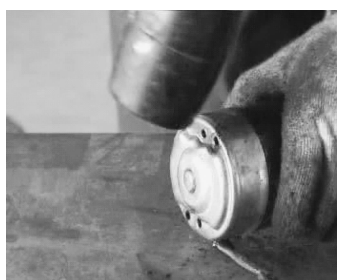
图 3-19 胶锤敲击拆卸
