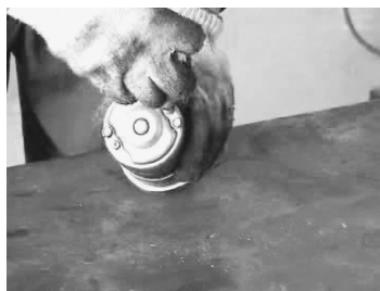
图 3-16 轴承后端盖紧固螺钉拆卸(1)
