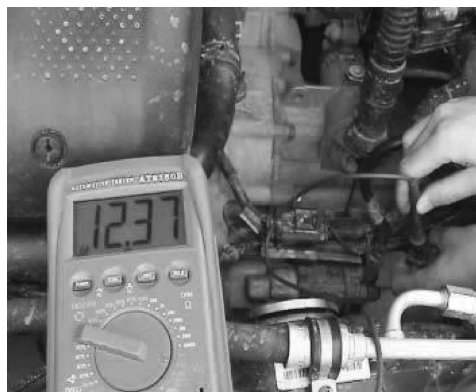
图 3-39 起动机起动信号检查(正常状态)
