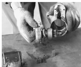
图 3-25 单向离合器总成拆卸完成
