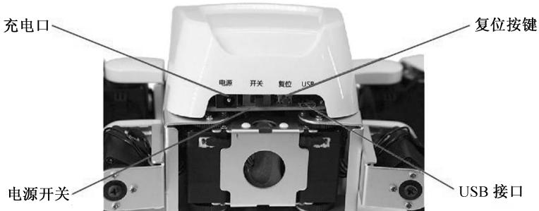
图 1.4 Aelos Pro 机器人硬件的组成
