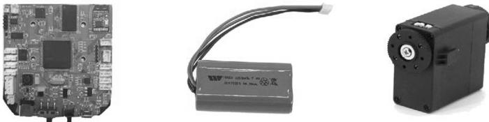
机器人控制系统——主控板 机器人动力系统——电池 机器人传动系统——舵机
