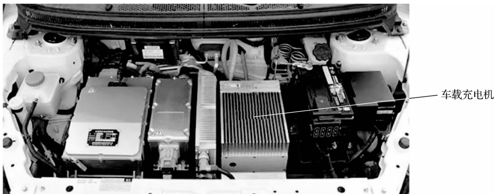
图 1-18 北汽新能源 EV160/200 独立式车载充电机
