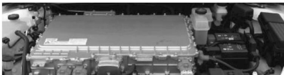
图 1-10 比亚迪 e5 电机控制器集成在高压电控总成中(四合一)
