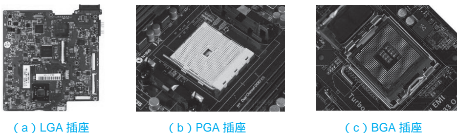
图 1-17 主板 CPU 插座形式
